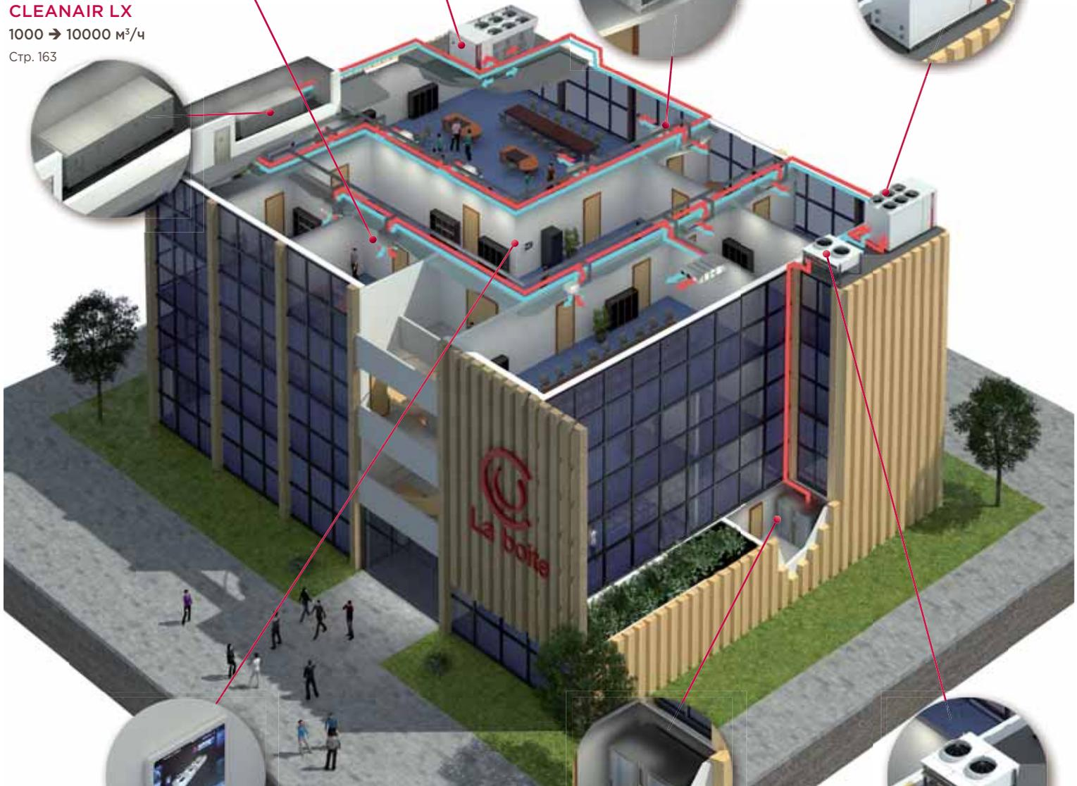
Система водяных контуров для отопления, вентиляции и кондиционирования воздуха
